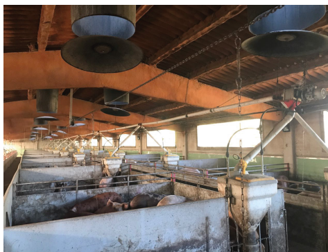
El sistema de cadena rotatoria que mueve los materiales de enriquecimiento de un corral a otro
