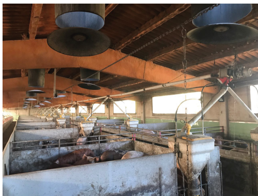
Láncalapú forgórendszer mozgatja az anyagokat
